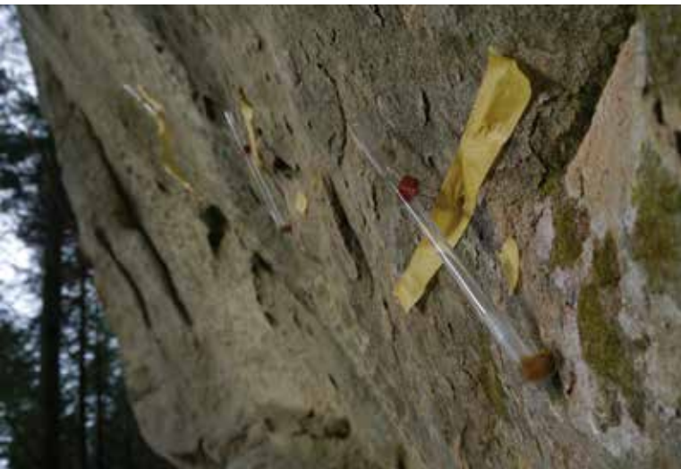
(Abb. 4) — Flüssigkeitsaufnahme nach Mirowski: bei dieser physikalischen Untersuchung wird eine Abschätzung des Zustandes des Gesteinsgefüges mittels des Vergleiches von absorbierter Flüssigkeitsmenge zur Aufnahmegeschwindigkeit vorgenommen. Um die Mobilisierung von Salzen Salzausblühungen zu verhindern (© Pieter Hellbach 2016).
