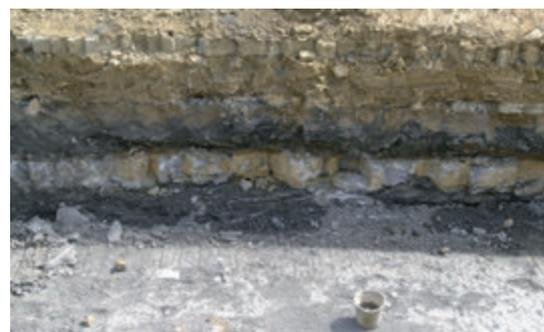
(*Abb. 3*) — Wechselfolgen von Kalkstein und Mergel. Geologischer Aufschluss im Baugebiet Contern-„An de Steng“ (Foto F. Dövenner © CNRA).
